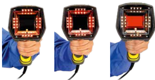
Éclairage à 30, 45 à 90°
