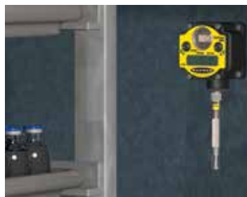
Capteur de température et d'humidité
